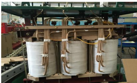
图5 安装完光纤传感器的变压器
